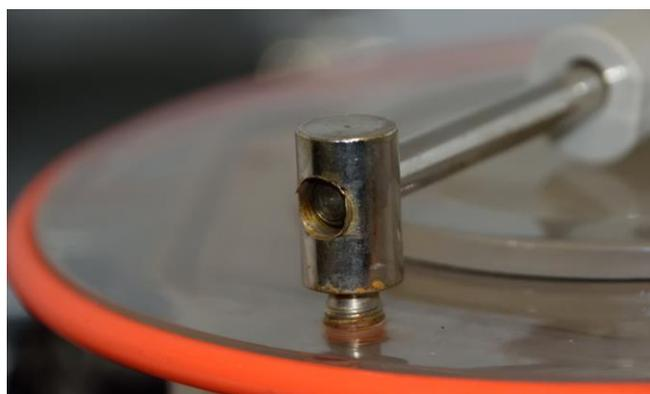
Pour régler la pression de la fermeture, en utilisant la pièce en plastique gris, il faut visser ou dévisser les 2 petits cylindres en fer. Cela a pour effet de les monter ou de les descendre afin de donner une pression + ou - importante lors de la fermeture. J'ai vu une vidéo d'un Youtubeur qui avait mis un bloc de post-it jaune pour bloquer le couvercle. J'espère qu'il verra ce tuto 😊
